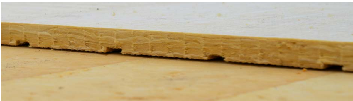
Eristeiden tuuletusurat yhdistetään kokoojakanavistoon sekä alipainetuulettimiin.
