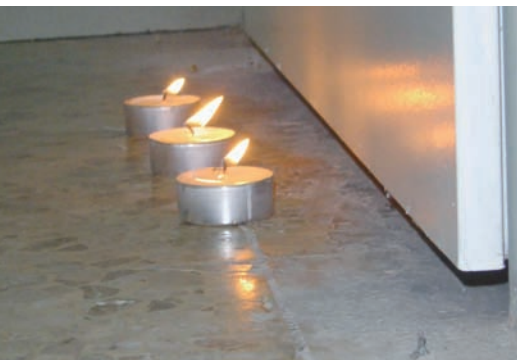
Esimerkiksi kynttilöiden avulla voidaan paikallistaa ilmavuotokohdat.
